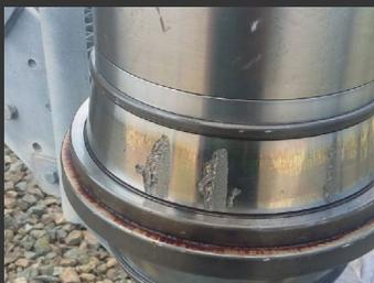
Schäden am Hochgeschwindigkeits-Wellenlager mit ecoCMS erkannt
